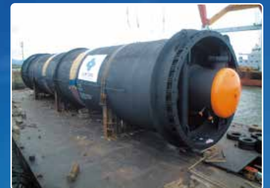
脱水素反応リアクター 寸法: 5,000ID×36,420L 板厚: 39.0mm 材質: SA240-TP304H
