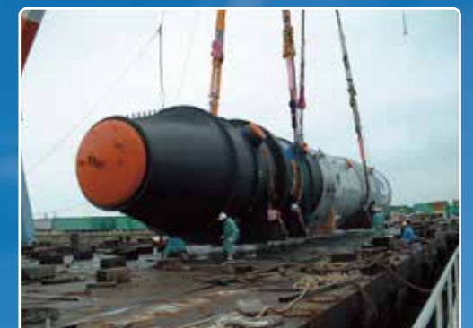
熱交換器 寸法: 4,370ID×32,720L 板厚: 19.0mm 材質: SA516-GR70/SA240-TP304H
