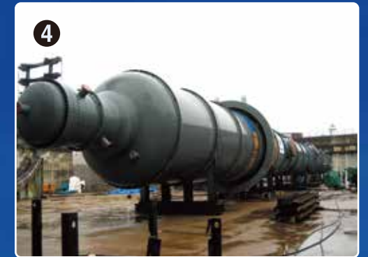
接触改質反応リアクター 寸法: 3,950ID×71,120L 板厚: 41.0mm 材質: SA387-22-1
