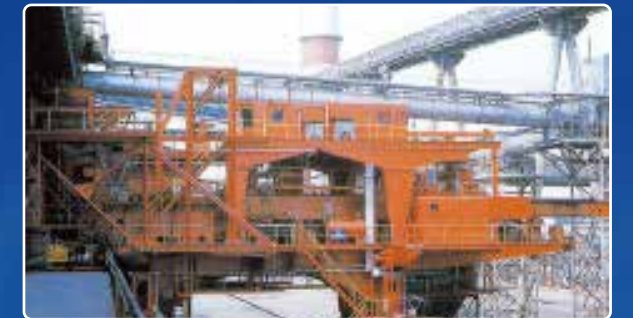
押出機：コークスを炭化室から押出
