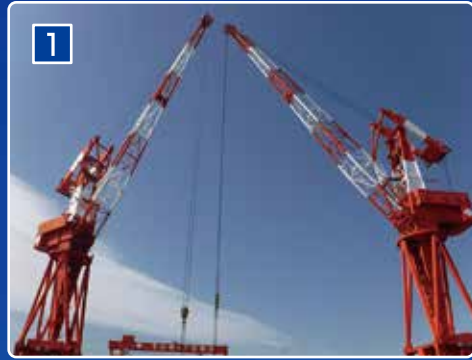
160トン吊りタワージブクレーン
