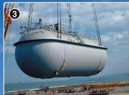
LPGタンク 寸法: 12,000ID×37,350L 板厚: 49.0mm 材質: KD63-M
