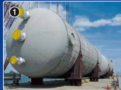
コークドラム 寸法: 9,800ID×38,300L 板厚: 38+3.5mm 材質: SA387-11-2+410Sクラッド
